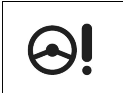
Lampu peringatan kerusakan EPS
