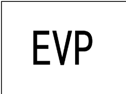
Lampu peringatan gangguan pompa vakum
