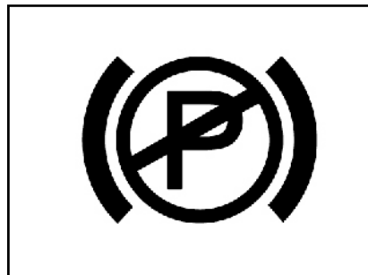
Lampu peringatan kerusakan EPB*
